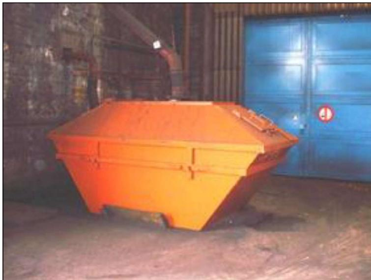
**Figure 9 : Collecte des fines dans une benne fermée**
