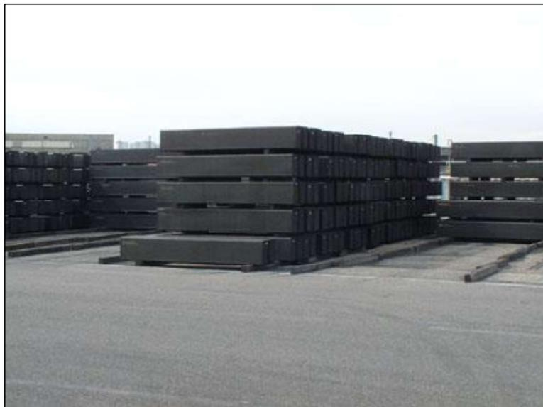
**Figure 3 : Stockage de cathodes crues devant le four F10**
